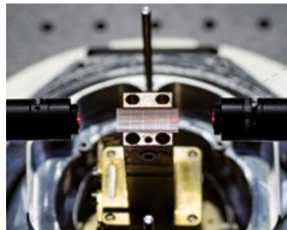
Optische Wellenleiterprobe im geöffneten Freistrahl-Kryostaten zur Untersuchung von Quanteneffekten bei tiefen Temperaturen
