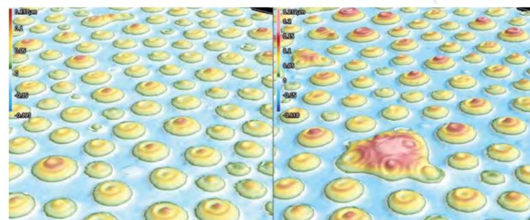
Mikrophasenseparierte Oberfläche einer PDMS-funktionalisierten Epoxidharzbeschichtung
