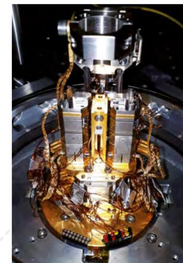
Tiefkalter Spektroskopieaufbau zur Untersuchung von quantenphotonischen Schaltkreisen und Quantenlichtquellen
