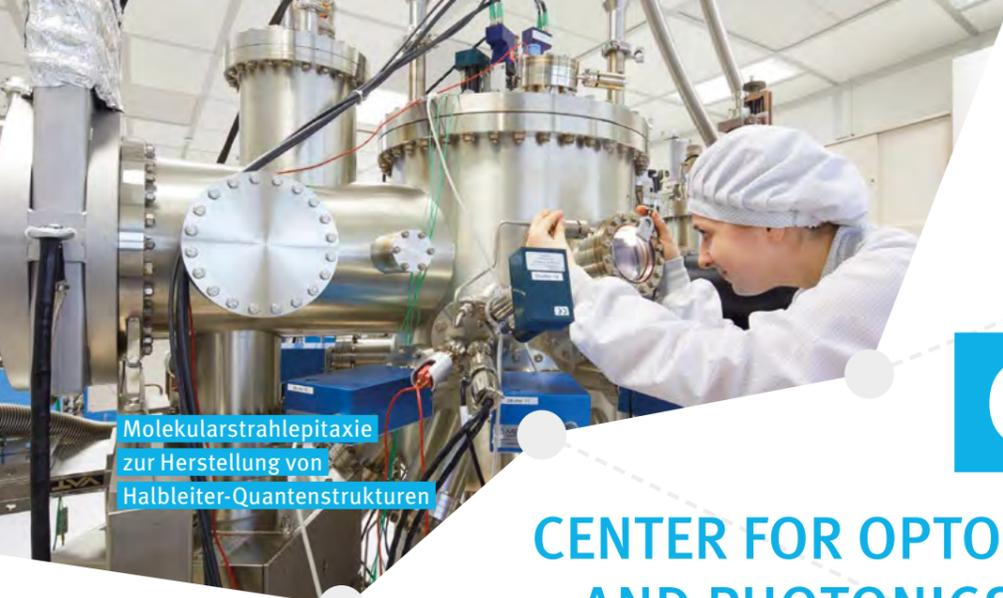
Molekularstrahlepitaxie zur Herstellung von Halbleiter-Quantenstrukturen
